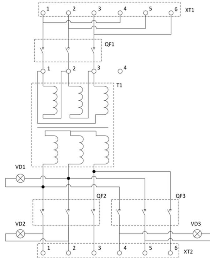
3.2. Изделия состоят из оболочки с салазками, вводного и распределительных автоматических выключателей, силового трансформатора напряжения, блока реле утечки (только для АОШ-Х-1-1), кнопочных выключателей, блока зажимов, светосигнальной арматуры, сальников ввода-вывода силовых и контрольных кабелей, шпилек заземления.
