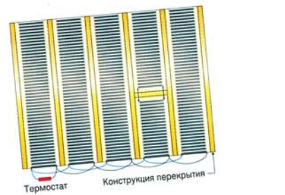
иллюстративная фотография монтажа ECOFILM C на металлические несущие элементы потолка
